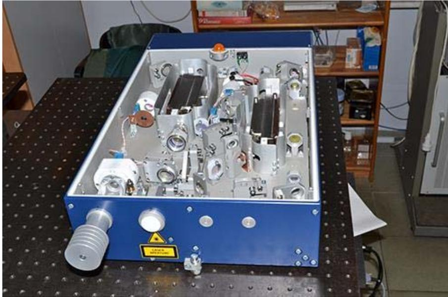
主振荡器有高稳定环形腔，预放大和高功率放大器产生  $\text{TEM}_{00}$  衍射受限光束，高脉冲能量，远场高斯光斑轮廓。高光谱辐射亮度，线宽不高于  $10\text{pm}$ ，使用内腔 F-P 干涉仪，使得高相干长度大于  $10\text{cm}$ 。
